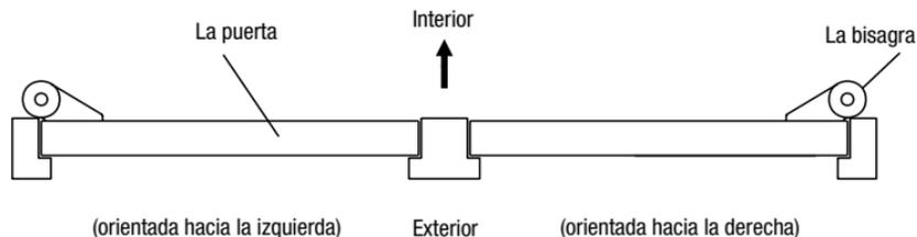
Controle que la dirección de la palanca coincida con la orientación de la puerta. De no ser así, cambie las palancas al seguir los pasos detallados a continuación.
